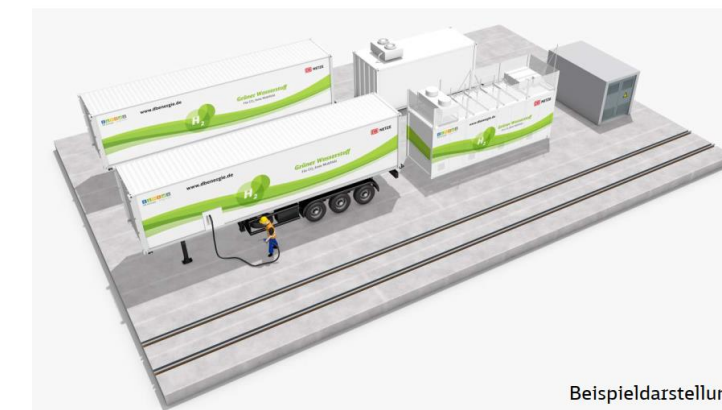
Mobile Wasserstofftankstelle Quelle: DB Netze
